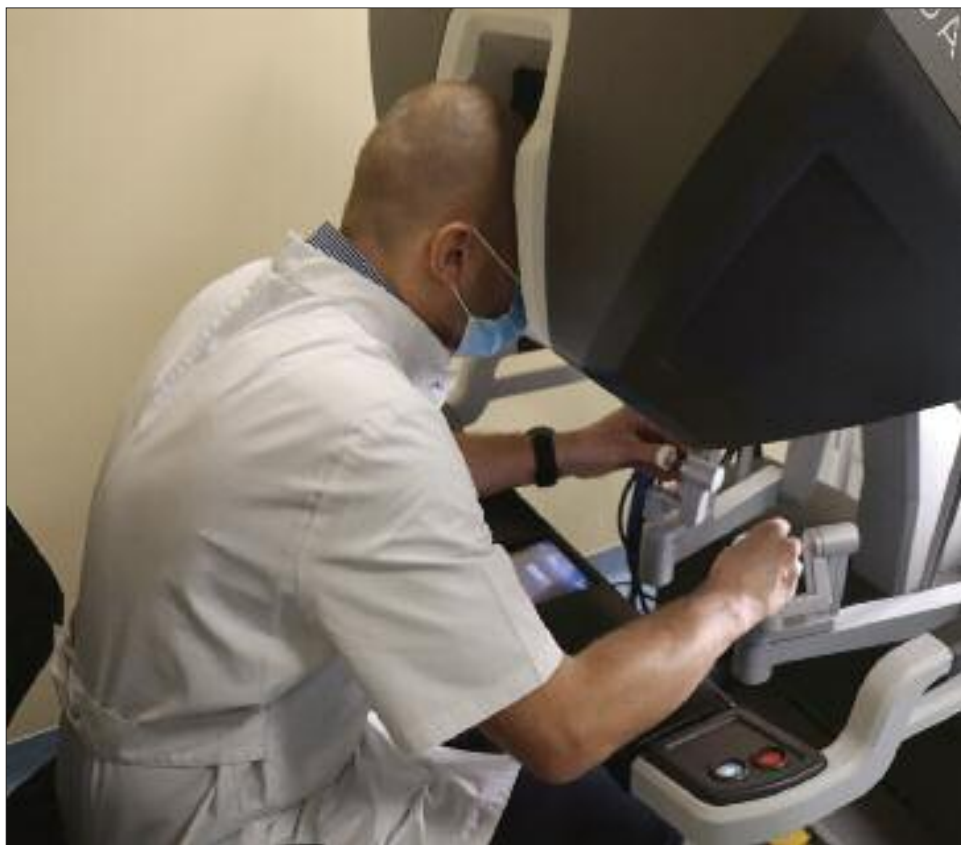
Lekarz wykonujący zabieg z zastosowaniem da Vinci nie znajduje się bezpośrednio przy stole operacyjnym, ale steruje końcówkami robota za pomocą specjalistycznej konsoli
