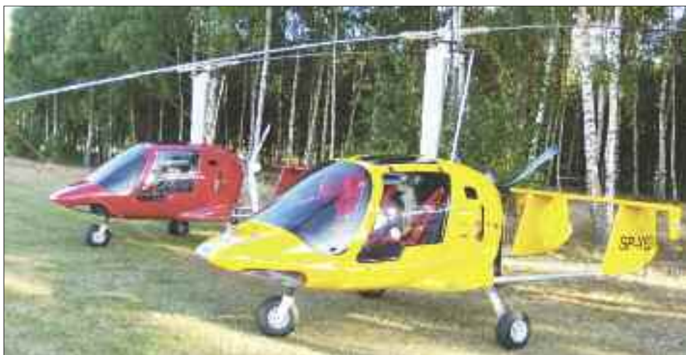
Wiatrakowce to nie są helikoptery, nie startują pionowo i potrzebują rozbiegu.
