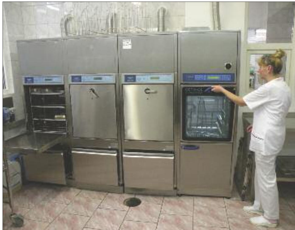
Mycie i dezynfekcja trwa 1,5 godziny w temperaturze ok. 90 stopni Celsjusza, a sterylizacja dodatkowe 60 minut
