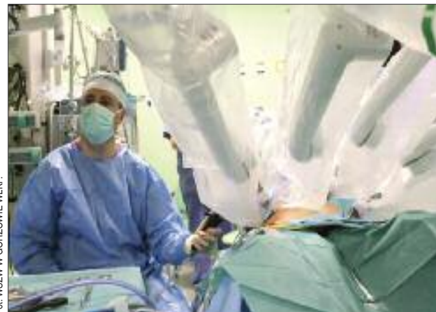
Robot da Vinci składa się z czterech ramion, które mają bezpośredni kontakt z pacjentem
